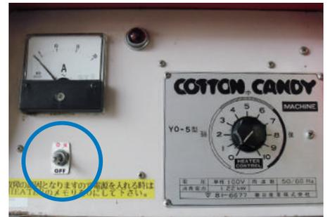
4 コンセントに電源を差し込み電源をONにする。
