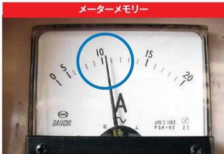
5 メーターメモリーを『10.5~12A』になるようにヒーターコントロールツマミを調節し、1~2分程度アルミ釜をカラ回しする。(ヒーター加熱) ※メモリーを上げ過ぎるとザラメを入れた際に煙がでます。
