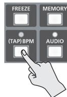
音楽のビートに合わせて [(TAP) BPM] ボタンを繰り返し押します。[(TAP) BPM] ボタンを押す間隔で、BPM が連続的に変更されます。変更された BPM に合わせて映像が自動的に切り替わります。
