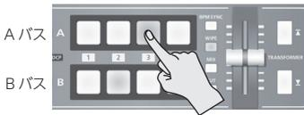
2. [(TAP) BPM] ボタンを長押し (2 秒以上) して、SETUP メニューを表示させる。
